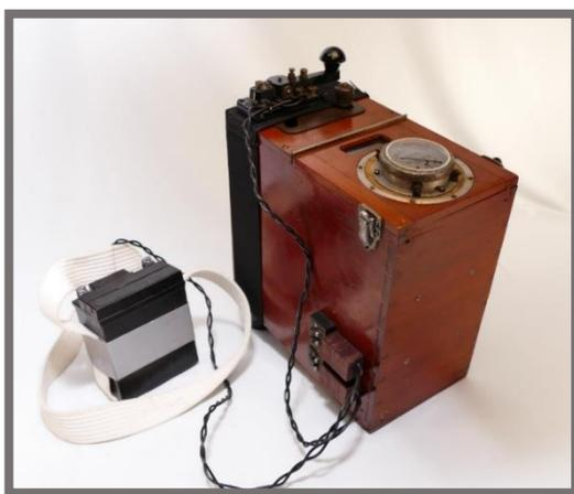
Photo N° 12 la Marconcina avec batterie de 12 Volt et manipulateur télégraphique fixée avec élastique
