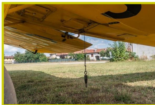
Photo N° 14 l'antenne de 25 mètres avec un poids suspendu d'environ 300 g qui sort de la carlingue
