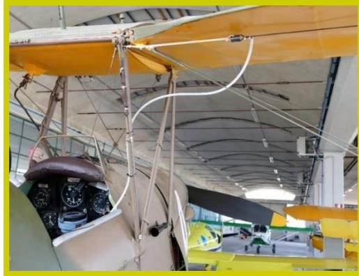
Photo N° 16 isolateur électrique et tube isolant fixés à l'entretoise Inter plan pour permettre au câble d'antenne de pénétrer dans la carlingue
